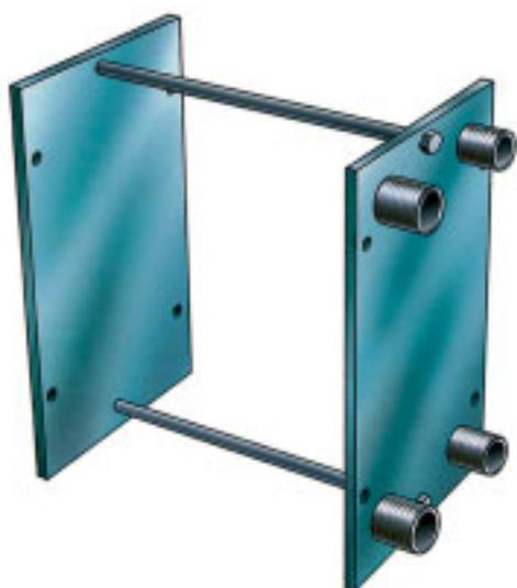
1. Рама теплообменника в собранном виде. Она состоит из опорной и прижимной плит, верхней и нижней несущих балок и патрубков.
