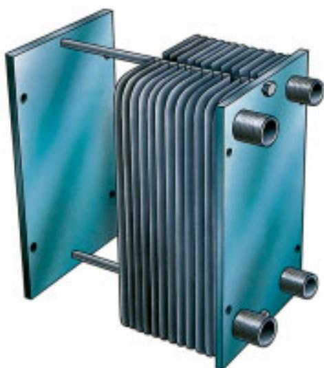
3. Затем в соответствии с техническими условиями устанавливаются остальные пластины.
