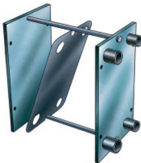
2. Первой устанавливается на раме концевая теплообменная пластина.
