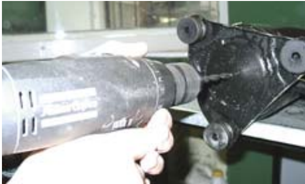
Для слива масла из роторного компрессора необходимо просверлить дно
