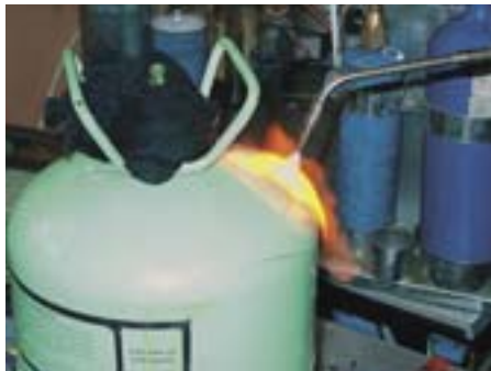
Нагрев места, где будет сделано отверстие
