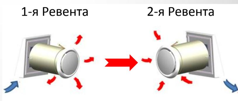
Через 70 секунд контроллер меняет направление движения воздуха на противоположное
