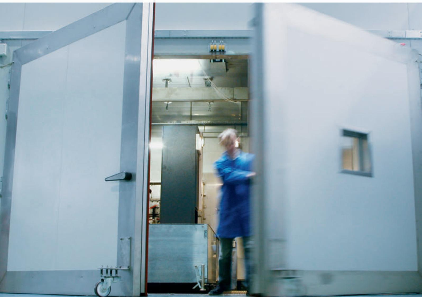
Испытание высокой готовности: еще на этапе проектирования в диапазоне температур от  $-20^{\circ}\text{C}$  до  $+55^{\circ}\text{C}$  в испытательном центре фирмы STULZ имитируются режимы нагрузки проектируемой системы кондиционирования воздуха. Полностью собранные системы кондиционирования воздуха подвергаются расширенным эксплуатационным испытаниям в климатической камере.
