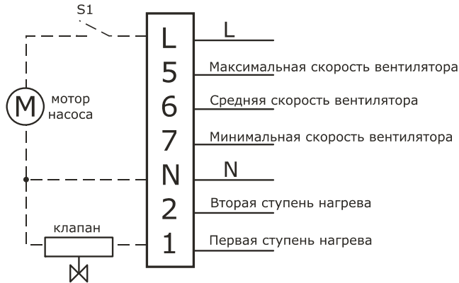
Электрическая схема подключения дистанционного пульта управления IR01
