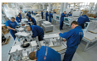
Цех изготовления приточно-вытяжных установок
