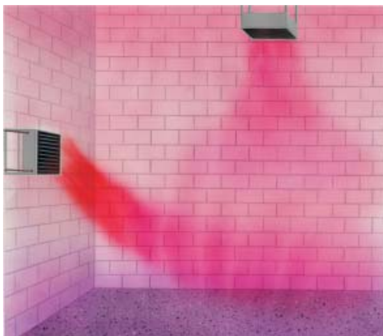
Объёмный поток для калорифера без теплообменника
